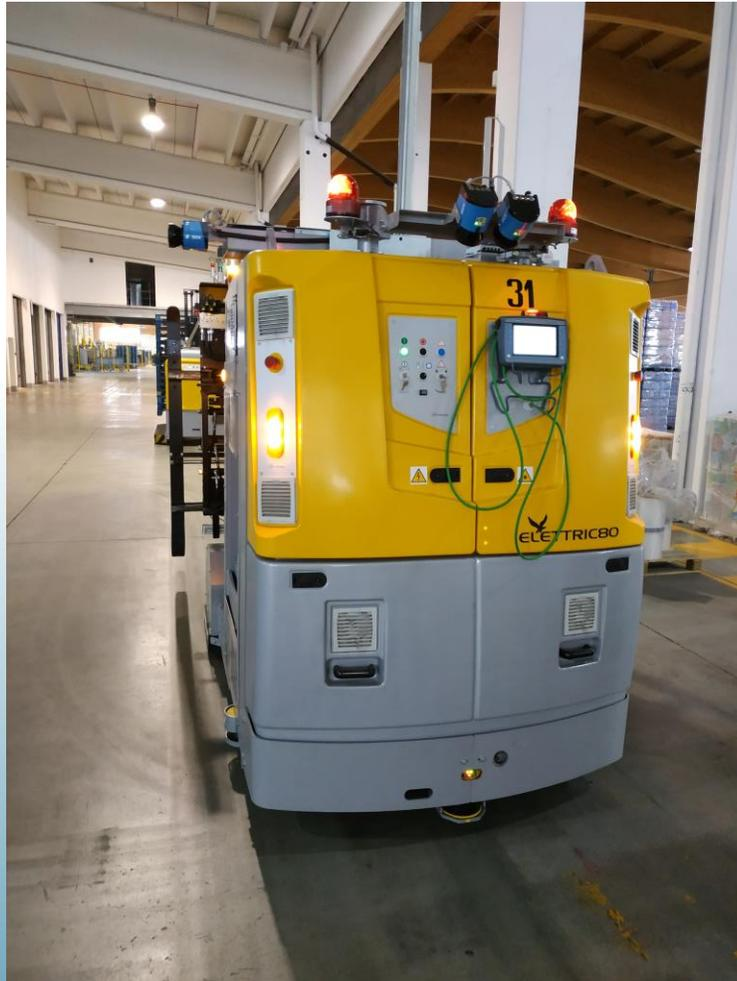
*LGV Laser Guided Vehicle a trazione anteriore e sollevamento idraulico ELETTRIC80*
