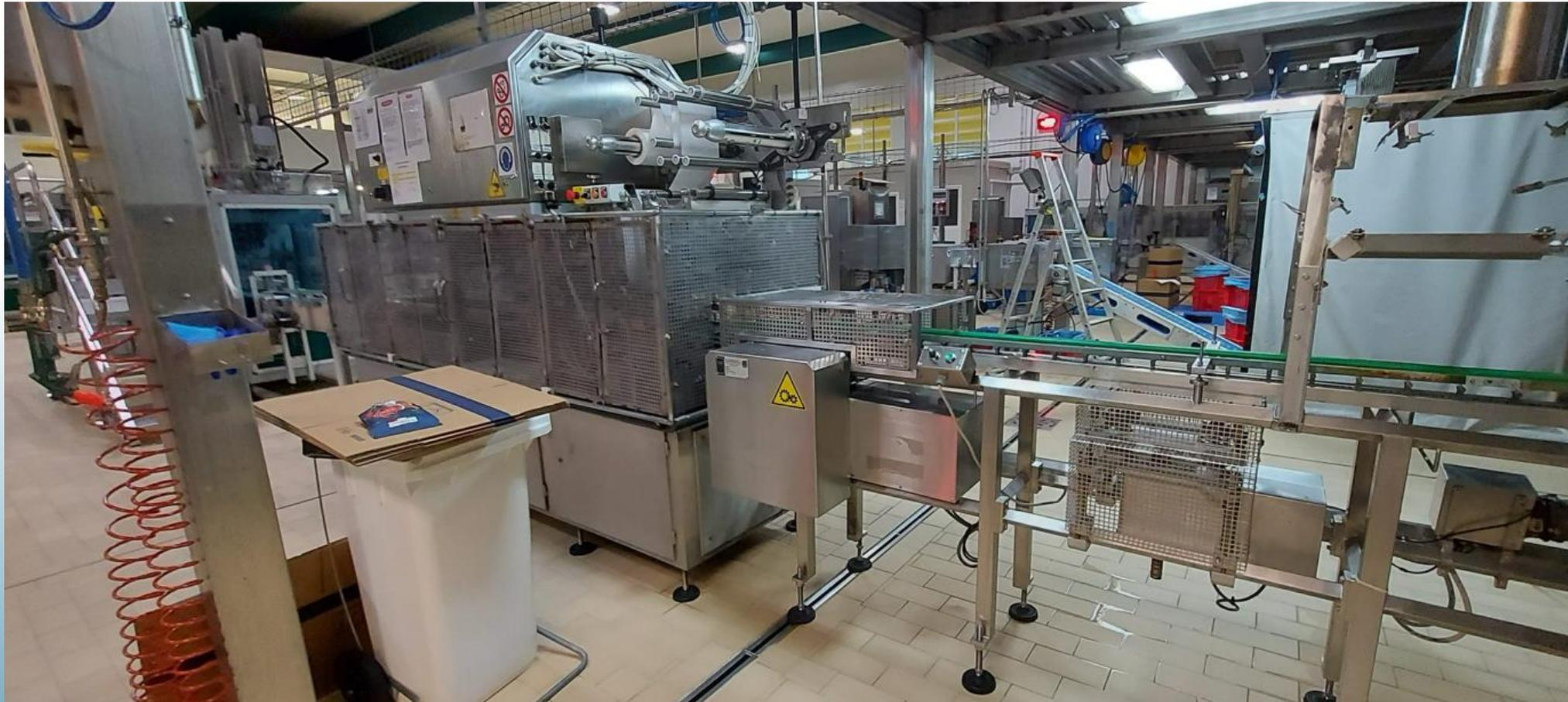
*Linea di impacchettamento alimentare con insufflaggio gas inerti per conservazione*
